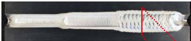
母材材質:硬質アルミ 板厚10mm Ar 100%
