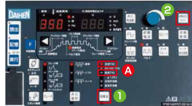
1 電極径 (1.6mmφ、2.4mmφ、3.2mmφ、4.0mmφ、4.8mmφ、5.6mmφ、6.4mmφが選択できます)
