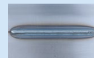
● 溶接電流: 300A ● 溶接電圧: 22V ● 板厚: 3.2mmt ● ワイヤ径: φ1.2mm ● 溶接速度: 150cm/min ● ワイヤ送給速度: 11.0m/min ● 突き出し: 15mm
