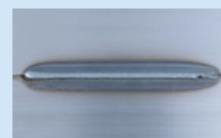
● 溶接電流: 300A ● 溶接電圧: 22V ● 板厚: 3.2mmt ● ワイヤ径: φ1.2mm ● 溶接速度: 150cm/min ● ワイヤ送給速度: 11.0m/min ● 突き出し: 15mm
