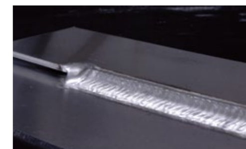
● 溶接電流: 120A ● 溶接電圧: 16V ● 板厚: 3.0mmt ● ワイヤ径: φ1.2mm ● 溶接速度: 50cm/min ● ウェーブ周波数: 2.5Hz
