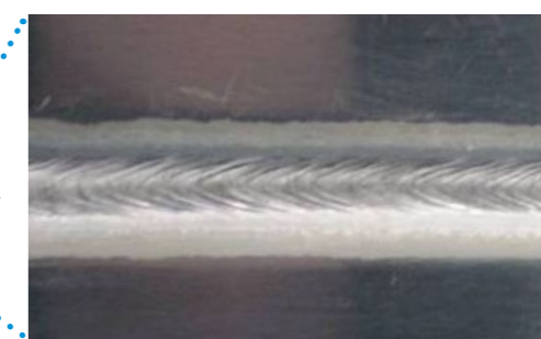
● 溶接電流: 280A ● 溶接電圧: 21V ● 板厚: 1.5mmt ● ワイヤ径: φ1.2mm ● 溶接速度: 160cm/min
