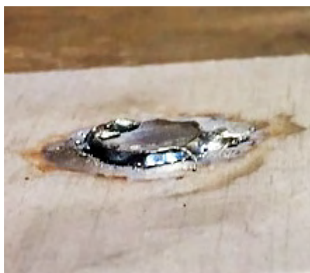
底部板材上的焊点
