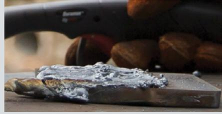
使用 FlushCut 平切易损件时，操作工能够确信：在切除吊耳、辅助附件或垫板后，留根小于 5 mm。
