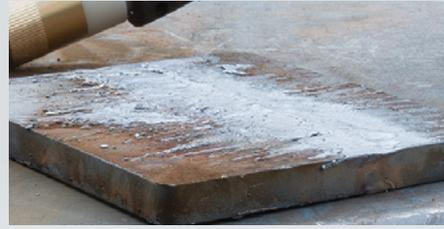
在切除辅助附件后，操作工可以降低系统安培数并铣创掉任何留根材料，而不会切割到工件内部。FlushCut 铣创进一步减少了所需的打磨工序。
