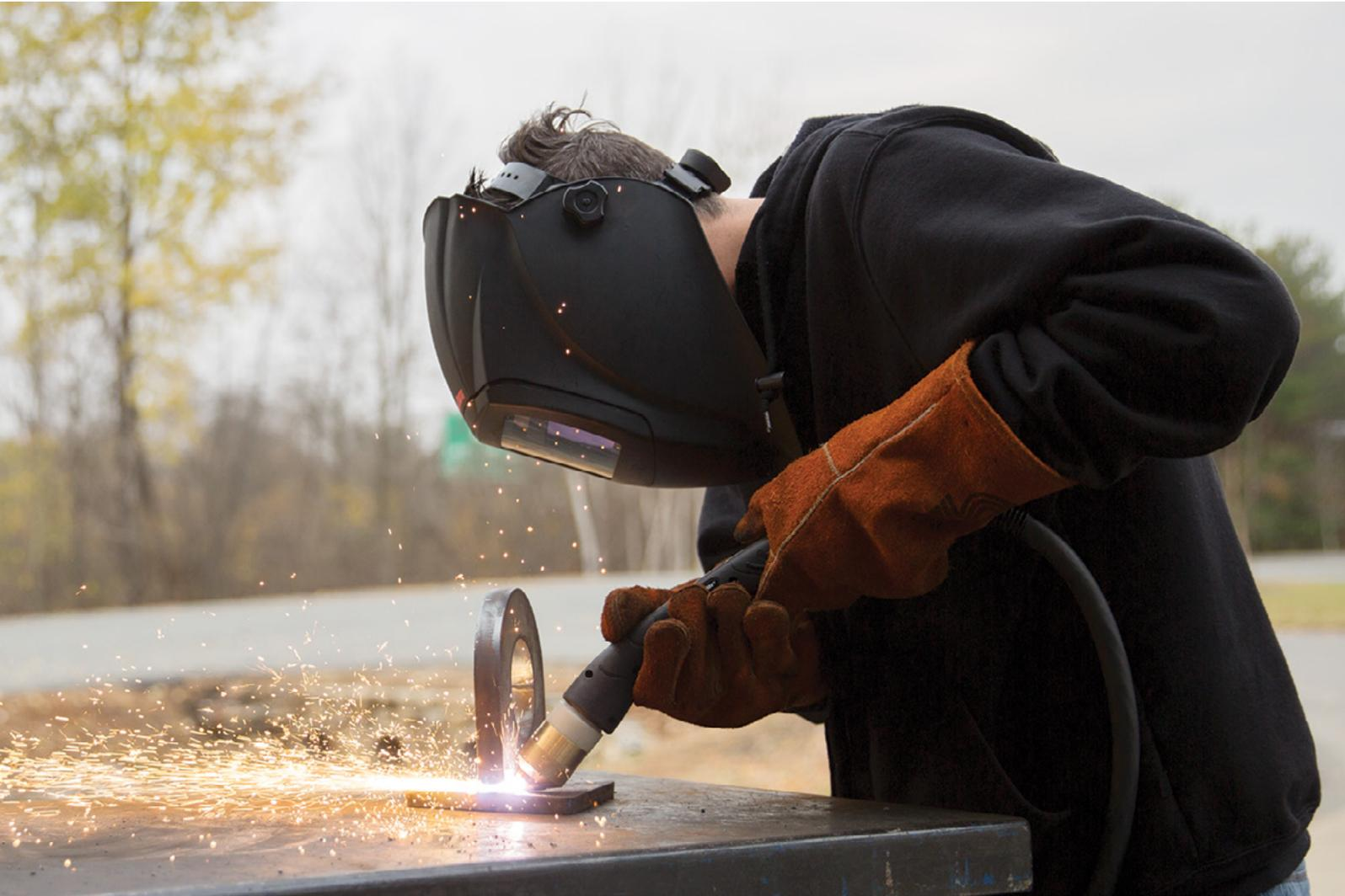
借助适用于特定 Powermax 系统的 FlushCut™ 平切工艺，用户在切割时能够比以往更加贴近基材。
